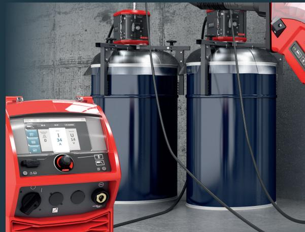
Automatisierter Wechsel zwischen zwei Drahtfässern
